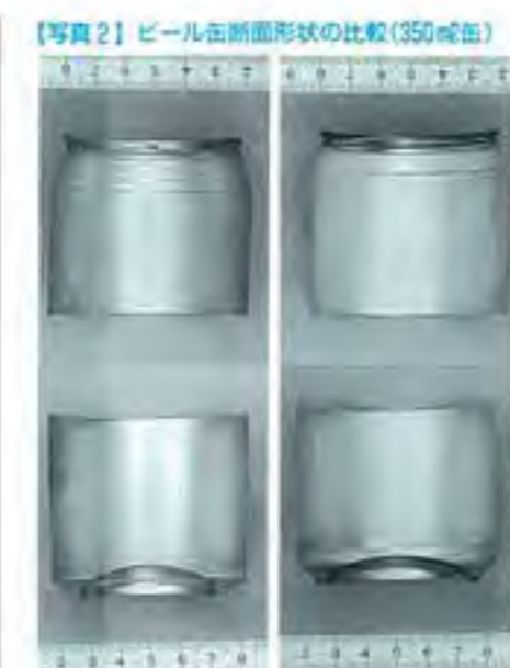
[写真2] ビール缶断面形状の比較(350ml缶)
