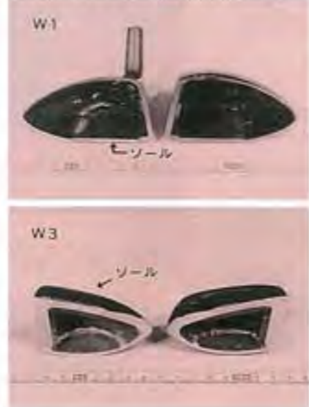
【写真1】ウッドクラブのヘッド（切断断面） 【写真2-1】ウッドクラブ(W1)ヘッドの顕微鏡組織（上は本体、下はソール） 【写真2-2】ウッドクラブ(W3)ヘッドの顕微鏡組織 【写真3】ゴルフクラブシャフト（断面）（左はW1、右は#5、いずれもシャフトのほぼ中央部断面）
