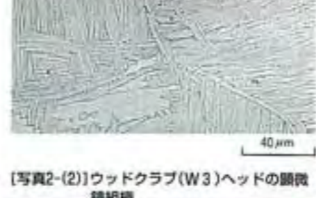
系（フェース部を含む）のチタン合金で、ソールにはチタンが用いられている。#3では、本体・天井板ともに3%のSiと0.8%のMgを含有するアルミ合金である。ヘッドの金属組織を【写真2】に、硬さの測定結果を【表2】に示す。#1と#3ではフェースの硬さに大きな差がある。#1、#3のシャフトはいわゆるカーボンシャフトである。グリ
