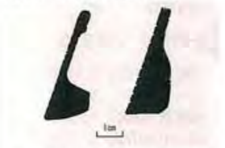
【写真4】アイアンクラブのヘッド断面
