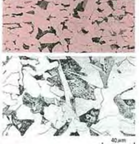
【写真5-1】アイアンクラブヘッドの顕微鏡組織（上は15、下は17）
