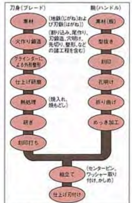
[図1]火作り法の製造工程
