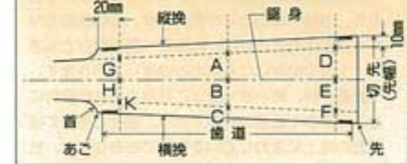
【図2】 歯先断面のかたさ【(A)】 HV(荷重1kg)
