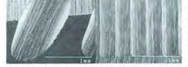
【写真4】マイクロエッジングの拡大写真(左:鉄A、右:鉄B)
