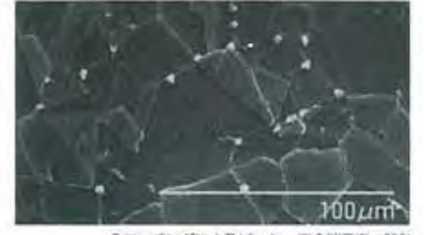
●エッチングによるピット 寿命消費率≦20% 【写真2】SUS304H鋼のクリープボイドのSEM観察(レプリカ法)
