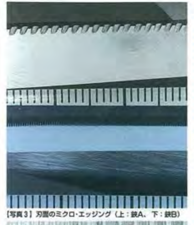
【写真3】刃部のマイクロエッジング(上:鉄A、下:鉄B)
