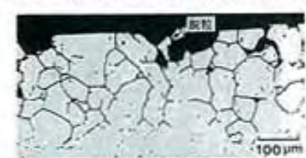
【写真1】鋭敏化した304鋼の粒界腐食(沸騰65%硝酸浸漬、14h)
