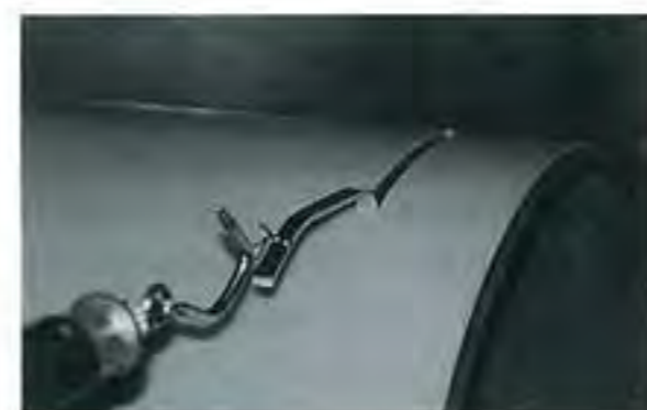
【写真4】剝離試験状況
