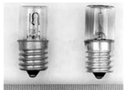
写真1 点灯管の外観
