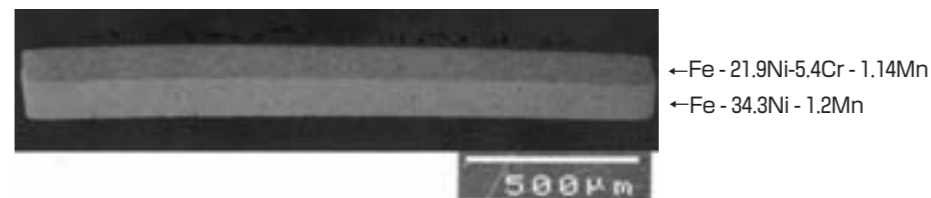
写真2 バイメタル部のマクロ組織
