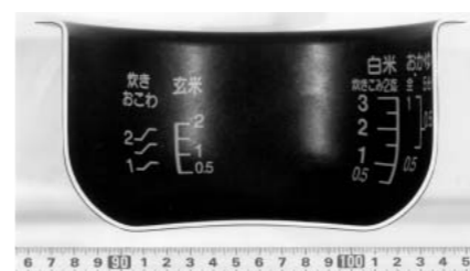
写真1 内釜の断面形状
