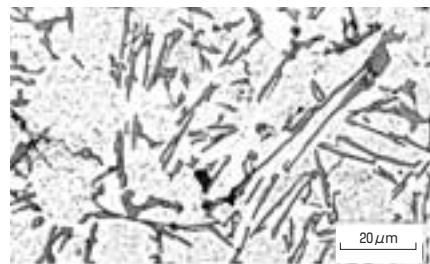
写真4 鍋の材料(A-Si共晶合金)
