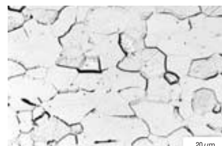
写真9 外装部材の光学顕微鏡組織(極低炭素鋼)
