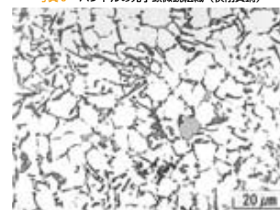
写真6 メインギアの光学顕微鏡組織(Cu-Zn-Aℓ-Si-Mn合金)
