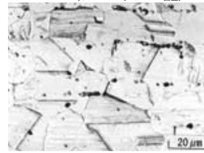
写真7 本体固定板の光学顕微鏡組織(18-8ステンレス鋼)
