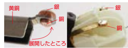
写真5 受電部と給電部の端子
