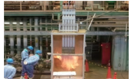
写真2 マルチスリットバーナ燃焼試験
